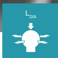
Значение  $L_{DIA}$  представляет собой максимально допустимую погрешность при разных положениях манипулятора. Поэтому оно характеризует повторяемость измерений.
