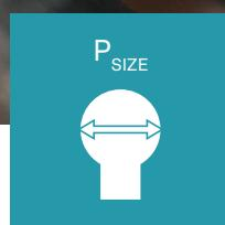
Значение  $P_{SIZE}$  представляет собой максимально допустимую погрешность при измерении диаметра сферы. Поэтому она характеризует погрешность измерений отдельных мелких деталей и элементов.
